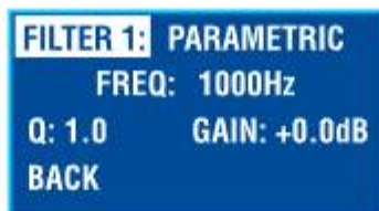
Fig. 5: modifica dei parametri dei filtri del preset USER Fig. 5: edit the filters' parametric values of the preset USER
